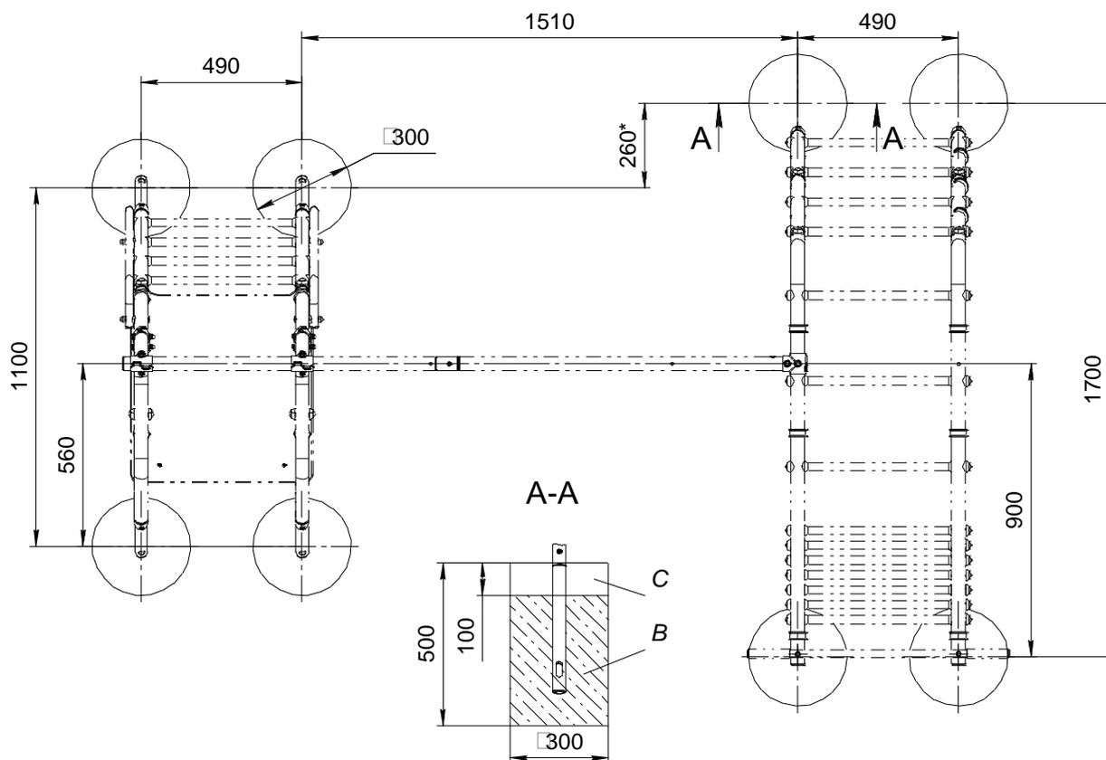
Для исключения люфтов при занятиях на комплексе рекомендуется при монтаже максимально распереть стойки лестниц, зафиксировать их в таком положении при помощи подручного материала (кирпичи, доски и т.п.), после этого забетонировать.
