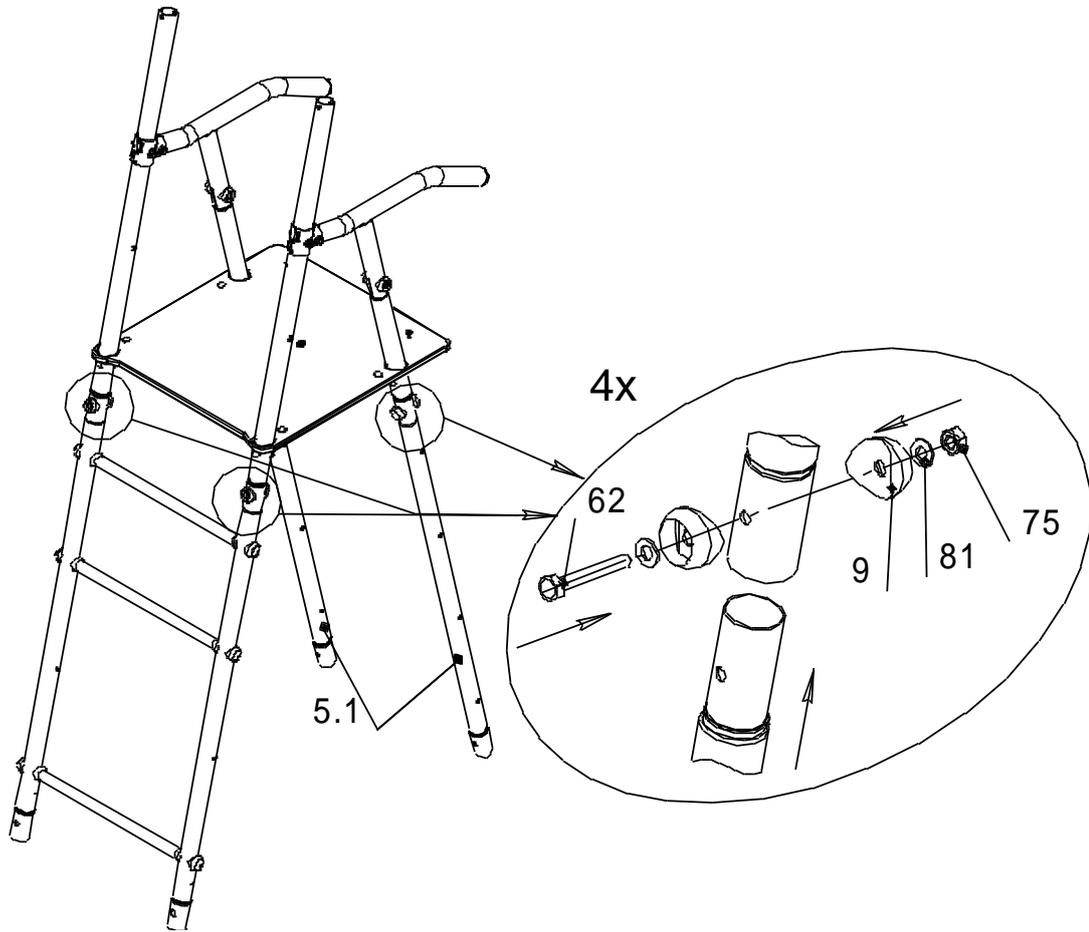
12 После установки поручней поз.8 **затянуть** весь крепеж при помощи ключа.
