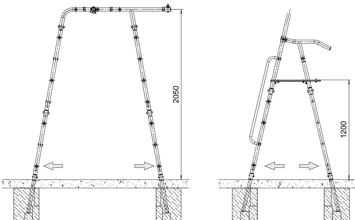
Эксплуатация комплекса допускается только после полного застывания бетона. Бетон необходимо закрыть синтетическим покрытием (резина) или дерном.
